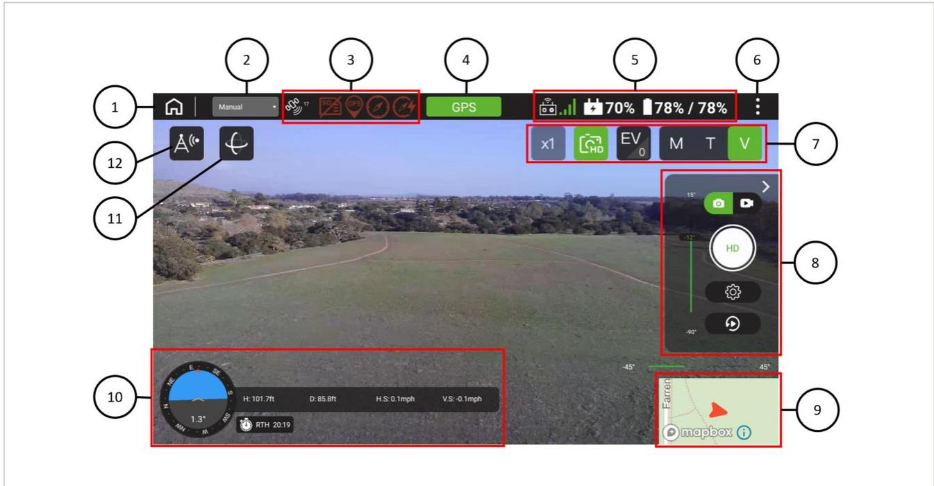
FIGURE 7.C GO FLY APP FLIGHT CONTROL SCREEN
