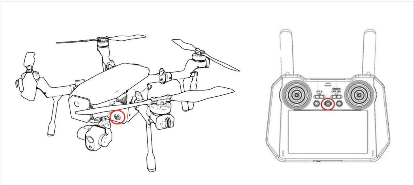
FIGURE 6.F AIRCRAFT AND CONTROLLER POWER BUTTON LOCATIONS
