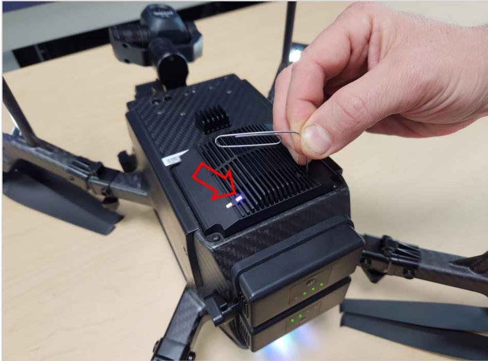
FIGURE 7.J PRESSING THE PAIR BUTTON (PAIRING LIGHT FLASHING)
